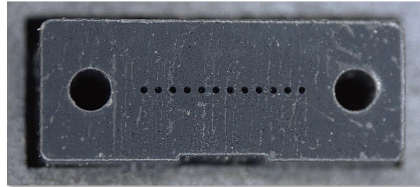
Ferula unui conector MPO
